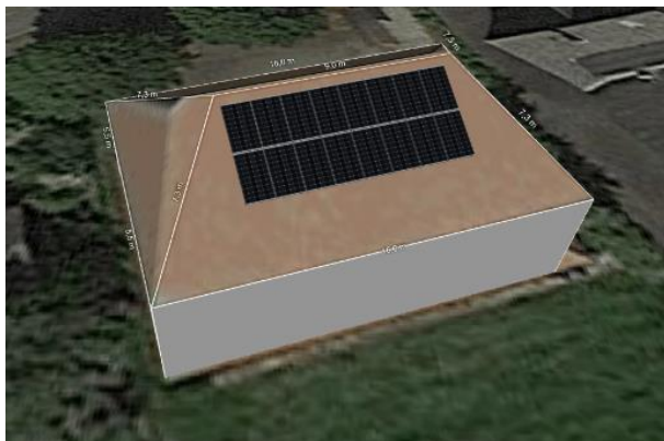
Abbildung 38: Ansicht der Modulauslegung (6 kW p )
